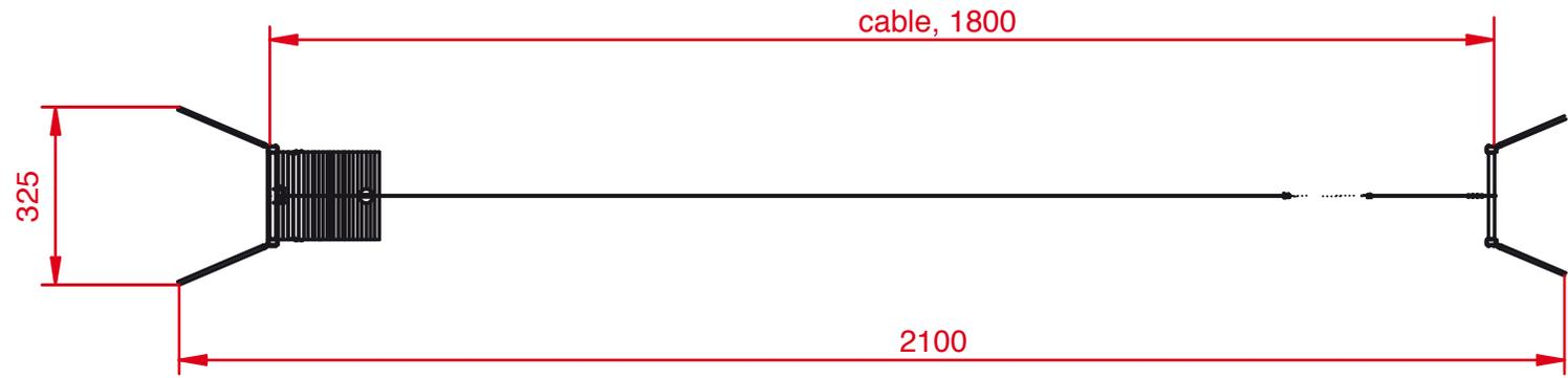
Área de seguridad para modelo de cable de 18 m. (Cotas en cm.)
