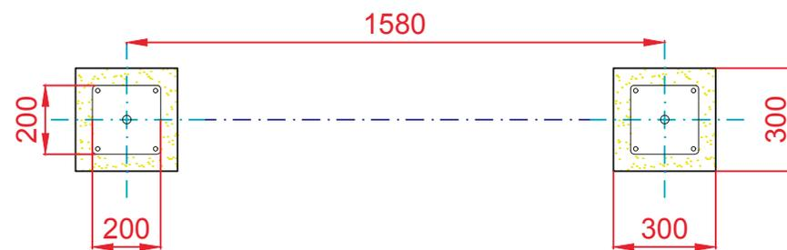
ESQUEMA DE CIMENTACIÓN EN HORMIGÓN
