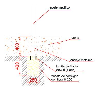
ESQUEMA DE CIMENTACIÓN EN HORMIGÓN
