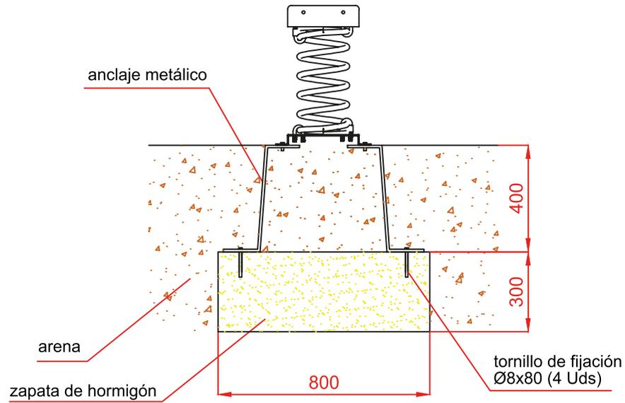
ESQUEMA DE CIMENTACIÓN EN HORMIGÓN
