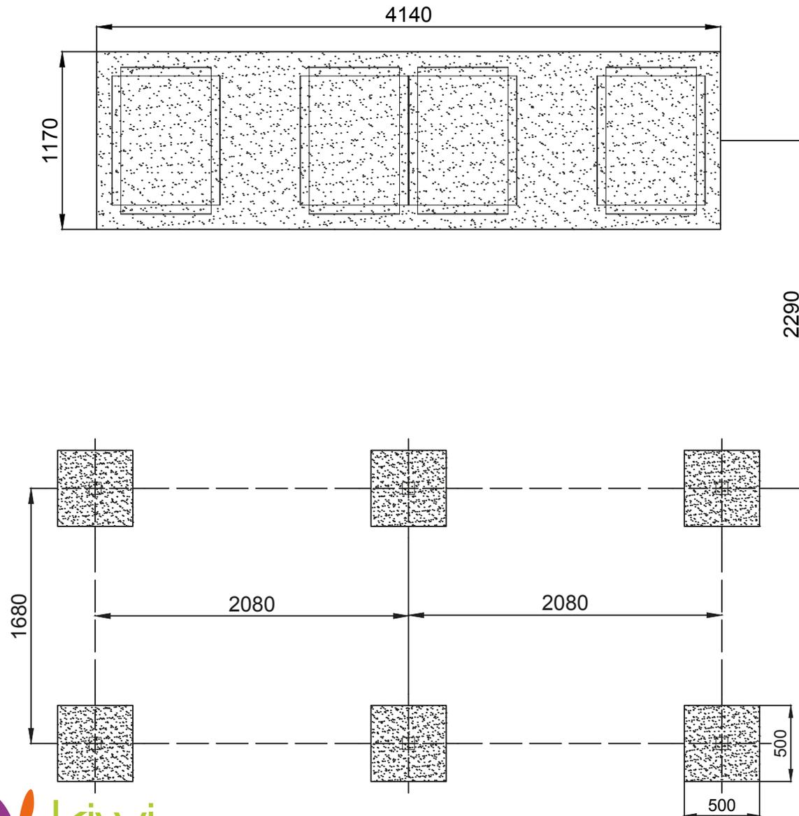
ESQUEMA DE CIMENTACIÓN EN HORMIGÓN
